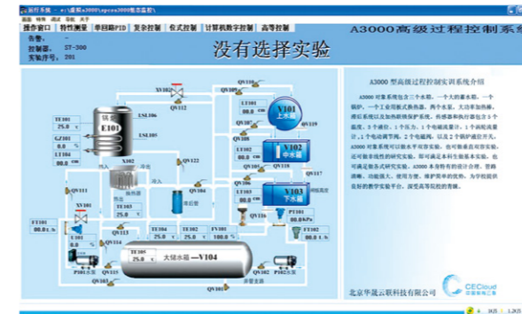
“自动化仿真实训系统”中针对真实或虚拟A3000具有相同的组态工程
