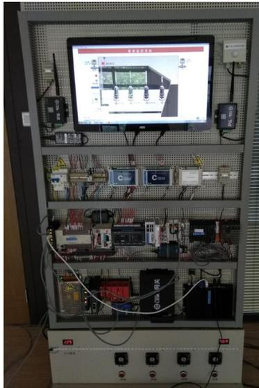
包括 1 套孔屏与配电系统，一个触摸屏，一个嵌入式紧凑型工控机。
