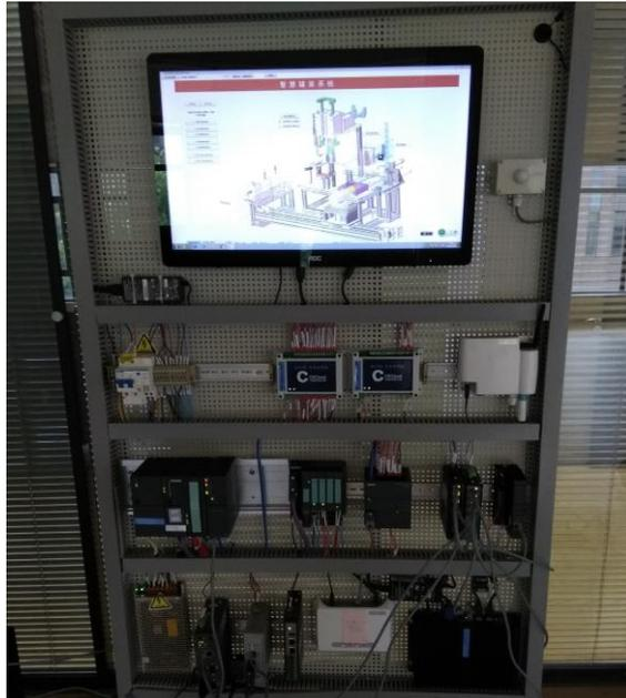
包括 1 套虚拟灌装质检生产线（纯软件）。具有五站功能，包括立体仓库，灌装站，封盖站，质检站，传送站，实现一个完整的送料，灌装，封盖，质检的过程。
